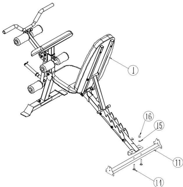
Установите задний стабилизатор (11) на основную раму и используйте два болта №14 M10x50, две плоские шайбы (15), две шестигранные гайки M10 (16), ключ с открытым концом № 15-13-17, чтобы зафиксировать детали.
