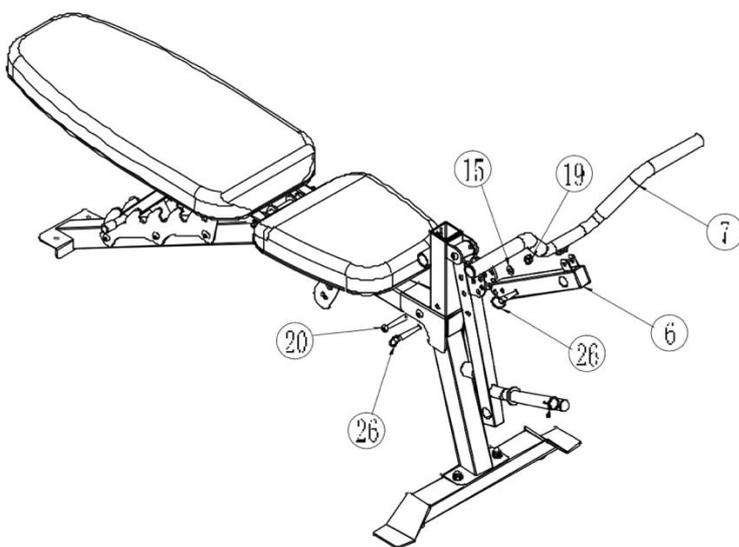
1. Установите стойку для поручня (6) на переднюю регулируемую стойку (5), а затем с помощью шестигранного болта (20), плоской шайбы (15), стопорной гайки (16), ключа (28) и шестигранного ключа (30) закрепите детали. Вставьте штифт  $\varnothing 10*65$  (26) для фиксации.
