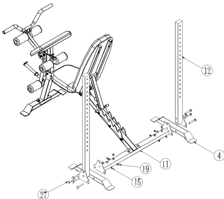
1. Вставьте винты (27) в отверстия на силовой раме (12), стабилизаторе (4) и нижней раме для гантелей (11), затем и используйте открытый ключ (28), плоскую шайбу (15)
