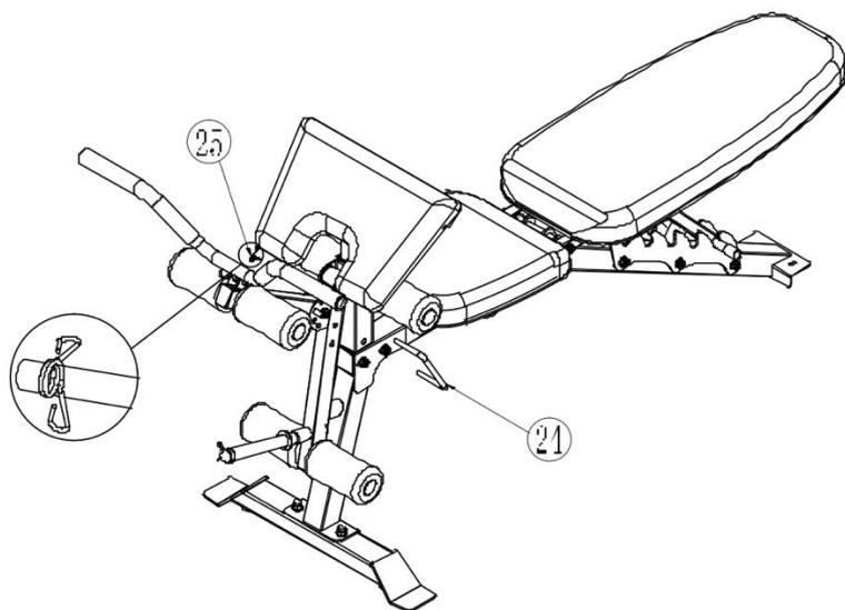
1. Вставьте стержень с крючками (24) в переднюю опору (2) и опору для ног (5), затем установите ограничительное кольцо  $\varnothing 10$  (25), чтобы закрепить детали.
