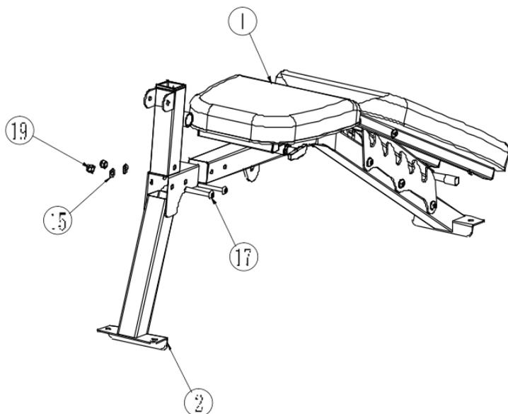
1. Установите переднюю стойку (2) на основную раму (1), а затем используйте болты М10\*65 (17), шайбу (15), гайку (19), ключ (28) и шестигранный ключ (30), чтобы закрепить детали.
