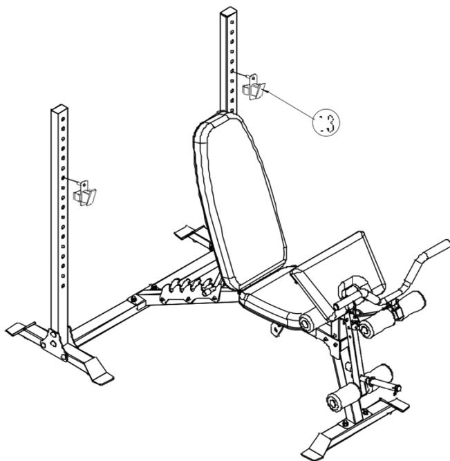
Крепления для гантелей (13), как показано на рисунке, можно вставлять в разные отверстия, чтобы регулировать высоту штанги в соответствии с различными размерами. Сборка завершена.
