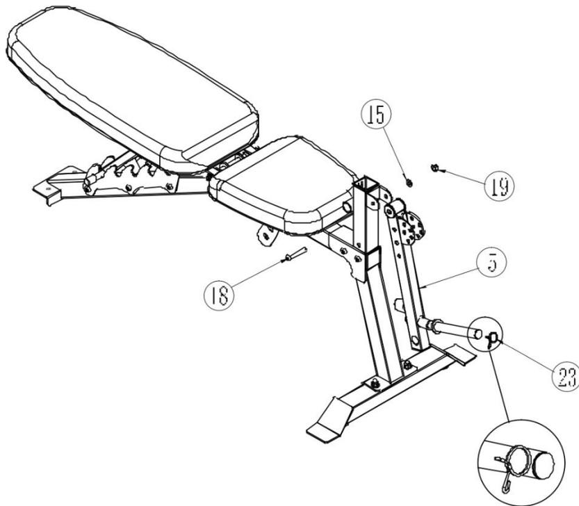
1. Установите переднюю регулировочную стойку (2) на основную раму (1), затем с помощью шестигранного болта (18), плоской шайбы (15), стопорной гайки (19), ключа (28), шестигранного ключа (30) и кольца  $\varnothing 25$  (23) закрепите детали.
